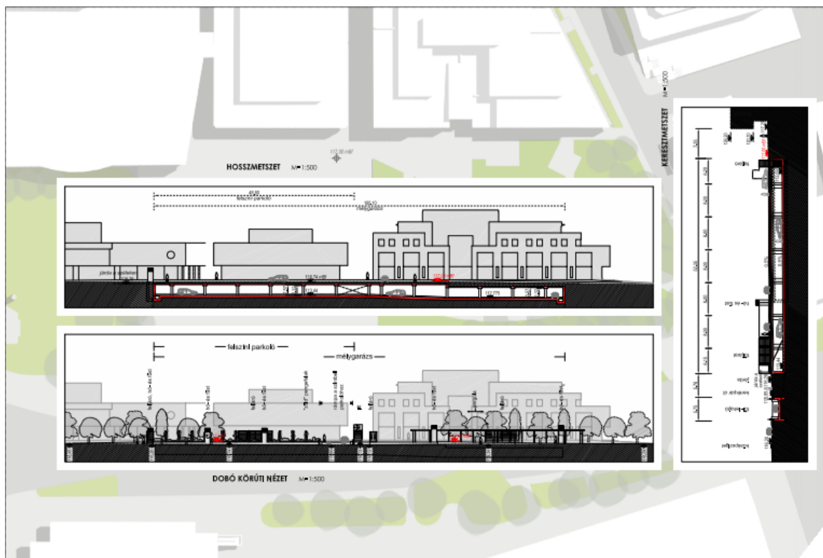
16. ábra: A Dobó körúton tervezett mélygarázs építmény metszete
