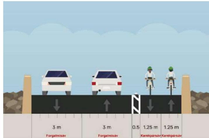
67. ábra: A Kiskunfélegyházi úti felüljáró lehetséges kerékpárosbarát átalakítása
