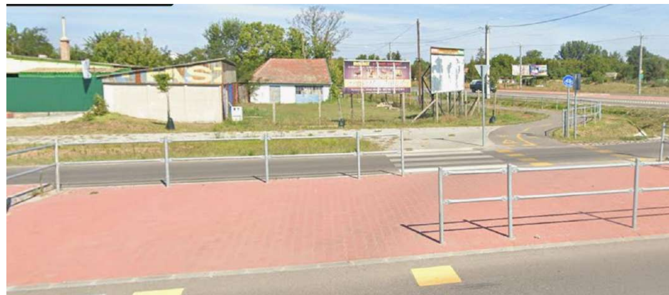
43. ábra: Megfelelő kerékpáros átvezetés a Károly Róbert körút - Budai út csomópontban
