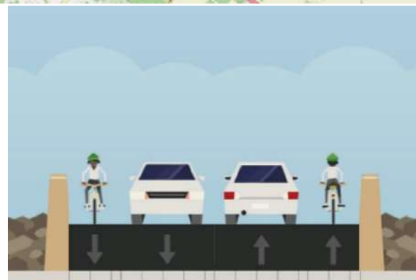
65. ábra: Boróka utcai felüljáró lehetséges ideiglenes kialakítása
