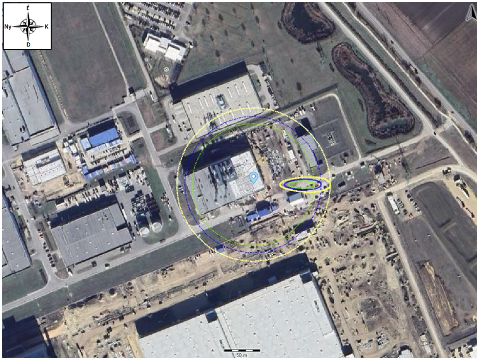
52. ábra: A hőszivattyúban alkalmazott hűtőközeg ammónia, mely a berendezésen belüli zárt körben cirkulál, létrejövő 1%-os halálozási valószínűség (F3 légkör állapot, zöld kontúr). 17,07 m létrejövő 1%-os halálozási valószínűség (F3 légkör állapot, kék kontúr).
