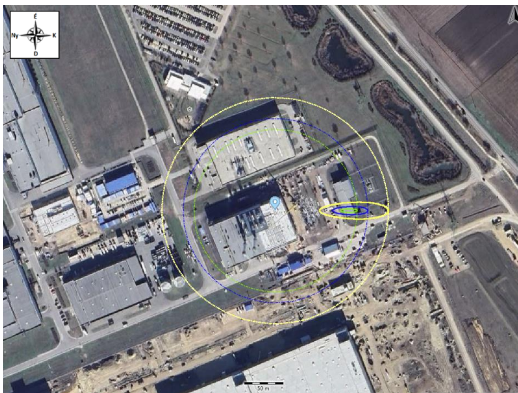
56. ábra: A hőszivattyúban alkalmazott hűtőközeg ammónia, mely a berendezésen belüli zárt körben cirkulál, létrejövő 1%-os halálozási valószínűség (F3 légkör állapot, zöld kontúr). 17,07 m létrejövő 1%-os halálozási valószínűség (F3 légkör állapot, kék kontúr).
