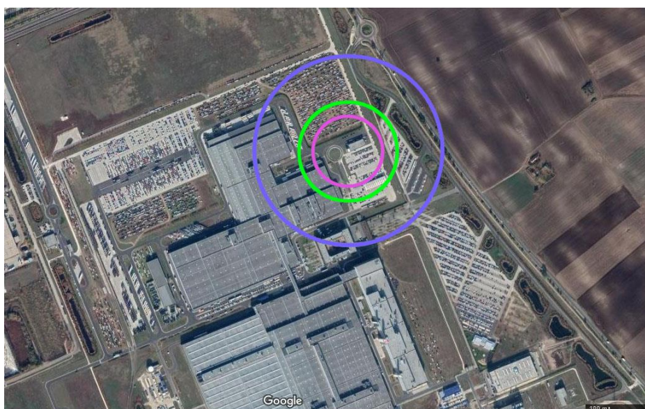
13. ábra: Az 1%-os halálozási övezet (zöld kontúr) távolsága, R = 123 m. A 10 \text{ kW/m}^2 hőszugárzási érték (kék kontúr) távolsága, R = 237 m A tűzgömb (rózsaszín) legnagyobb sugara, R = 85 m
