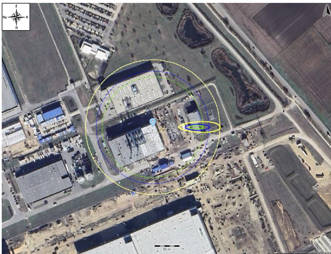
54. ábra: A hőszivattyúban alkalmazott hűtőközeg ammónia, mely a berendezésen belüli zárt körben cirkulál, létrejövő 1%-os halálozási valószínűség (F3 légkör állapot, zöld kontúr). 17,07 m létrejövő 1%-os halálozási valószínűség (F3 légkör állapot, kék kontúr).
