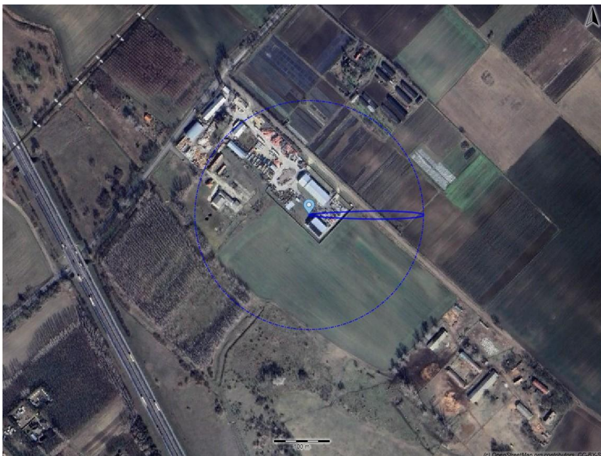
13. ábra: Raktártűz mérgező felhő terjedése az Akkumulátor tároló 1. helyiségéből (F3_HCN)
